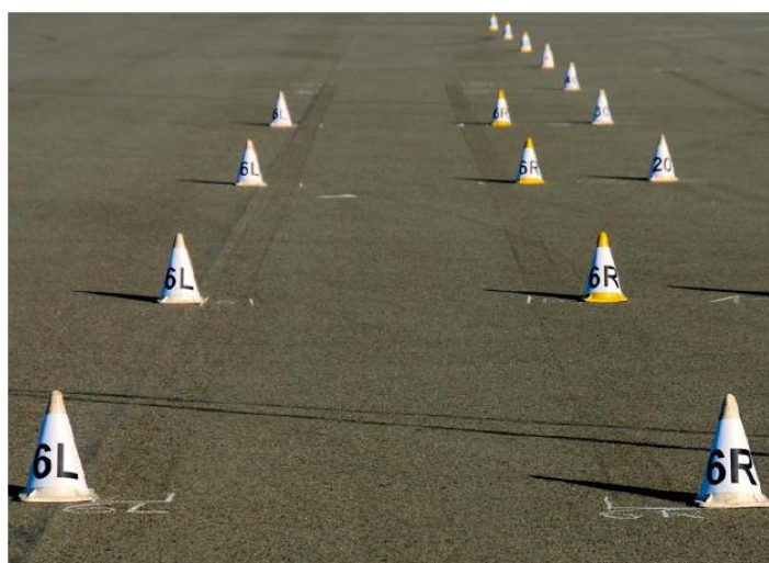
Figura 6 - Vestígios de frenagem - Mercedes-Benz CLK500 2005 com ABS (BAUMANN, et al., 2009)
