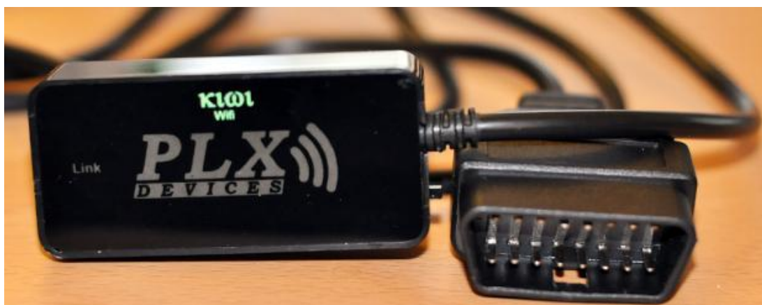
Figura 26 - Interface OBD II – Ensaio Preliminar. Adaptado de (PLX Devices)
